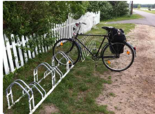
Abbildung 2: Typ Felgenklemmer (ungeeignet)
